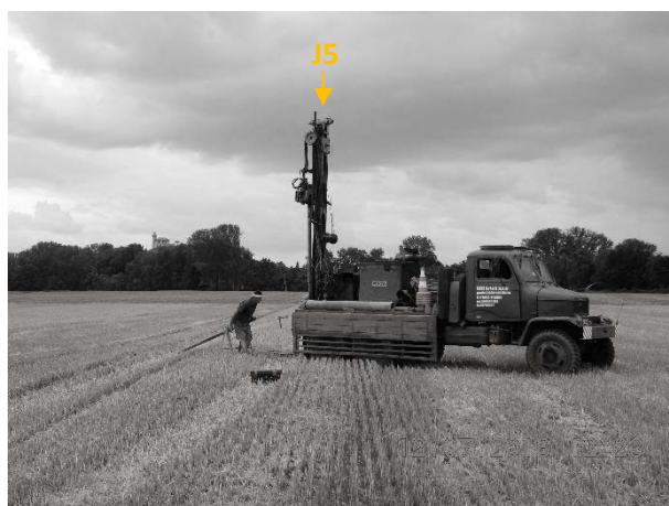
Obr. 1,2: Hloubení jádrových sond J1 (pohled k SZ) a J5 (pohled k JZ) strojní soupravou WIRTH na podvozku PV3S.
