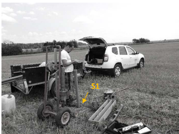
Obr. 5,6: Vsakovací zkoušky ve vystrojených sondách S1 (pohled k východu) a S2 (pohled k jihu).
