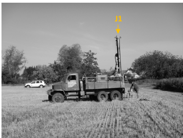
Obr. 1,2: Hloubení jádrových sond J1 (pohled k SZ) a J5 (pohled k JZ) strojní soupravou WIRTH na podvozku PV3S.
