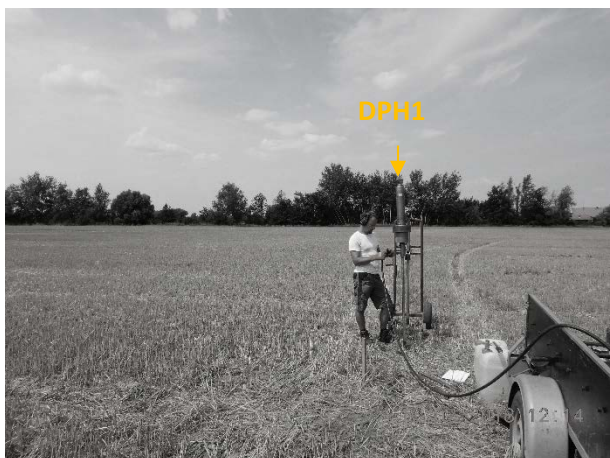
Obr. 3,4: Provádění zkoušky těžké dynamické penetrace DPH1 a DPH2 v pohledu k severozápadu.
