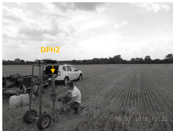
Obr. 3,4: Provádění zkoušky těžké dynamické penetrace DPH1 a DPH2 v pohledu k severozápadu.
