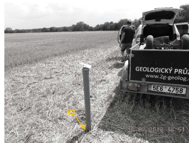
Obr. 5,6: Vsakovací zkoušky ve vystrojených sondách S1 (pohled k východu) a S2 (pohled k jihu).
